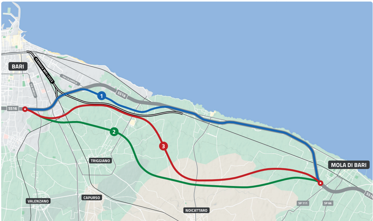
Le tre soluzioni progettuali alternative: Alternativa 1 (blu) – Alternativa 2 (verde) – Alternativa 3 (rosso). Con doppio tratto nero il tracciato previsto della nuova ferrovia Bari-Lecce
